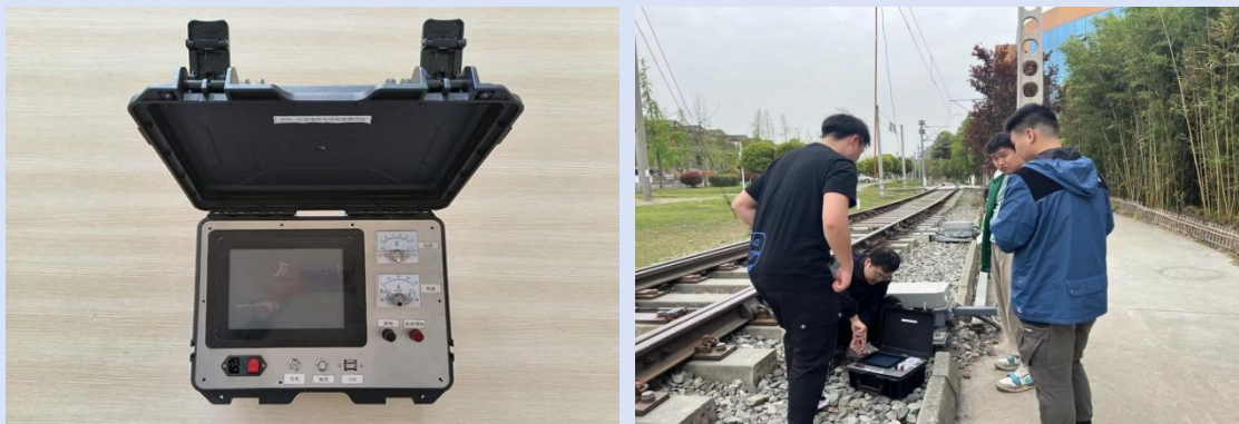
图 7-2 何柏杉老师团队为中铁一局研发产品新型地铁接触网短路试验模拟测试装置
